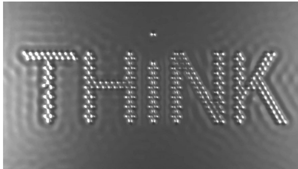
Figure 2. Think écrit avec des molécules de CO positionnées sur une plaque de cuivre. à -268,15\text{ }^{\circ}\text{C} par un microscope à effet tunnel. Chaque image fait 45 \times 25\text{ nm} . Extrait du film : A Boy and His Atom (IBM Research – Almaden)
